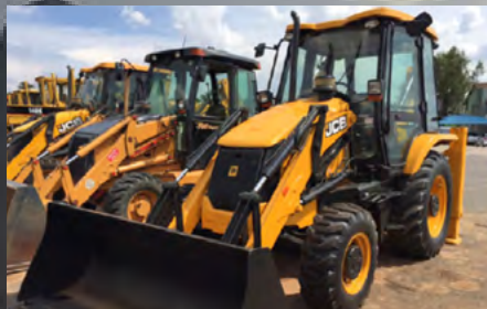
BACK HOE LOADER
